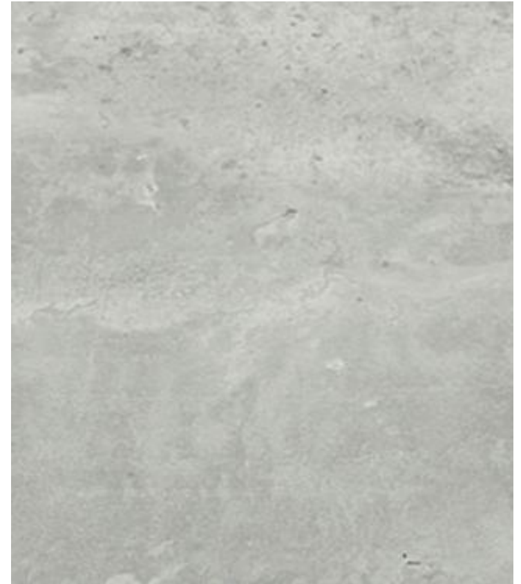
Pelare och synliga väggar Rå betong, dammbunden
